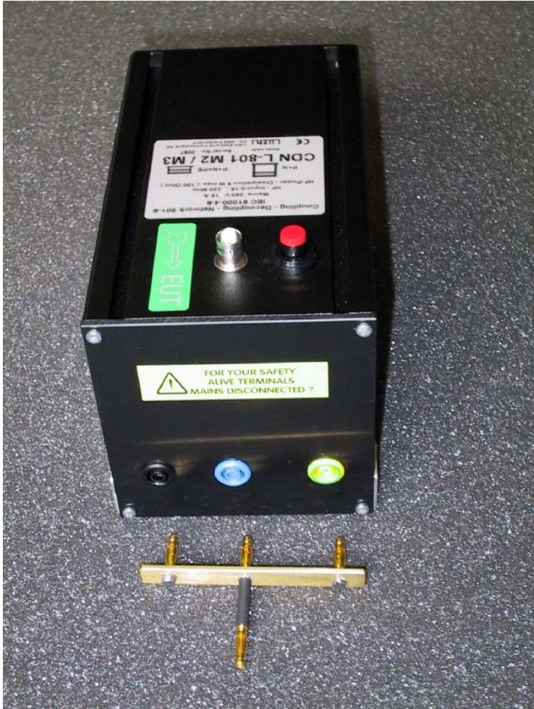
CDN, Netz 3 Leiter, umschaltbar, 4 mm Laborbuchsen
