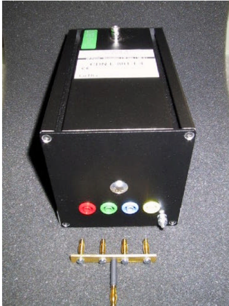
CDN, Erdsymmetrische Leitung, 4 mm Laborbuchsen
