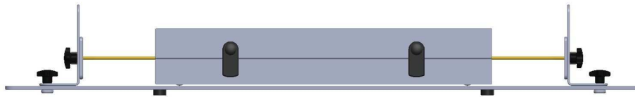
Abb. 5: CMAD 1614 im Kalibrieradapter mit Line 2 Fig. 5: CMAD 1614 in calibration fixture with Line2
