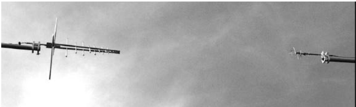
Kalibrierung des Bezugsnormal im Freifeld Calibration of the Site Reference under Quasi Free-Space Conditions
