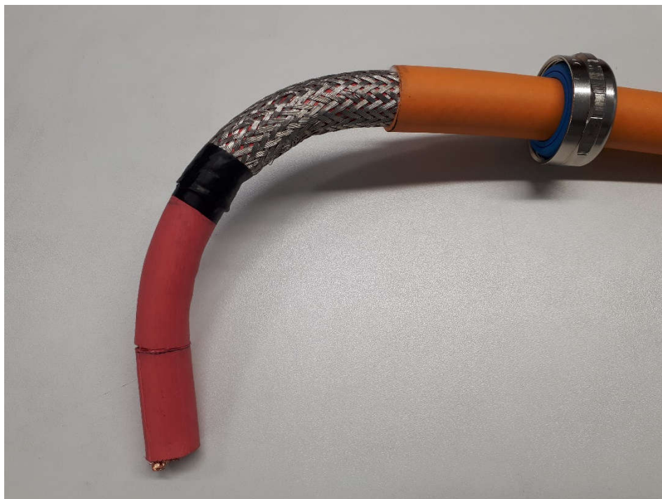
Bild 4: HV-Kabel nach dem Biegen mit fixiertem Schirmgeflecht und Überwurfmutter Fig. 4: HV-cable after bending with fixed shielding braid and locking nut
