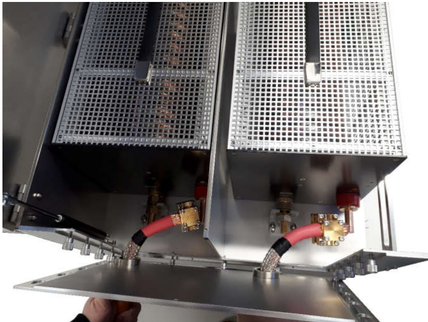
Bild 7: Einhängen der Flanschplatte mit HV-Kabeln und Klemmen Fig. 7: Attaching the flange plate with HV-cables and terminals
